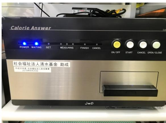
「カロリーアンサー」は金遠赤外線分析法という分析法を用いることで、測定サンプルの性状により「透過測定方式」または「反射測定方式」によって、測定物のカロリーのほかに、参考値として、たんぱく質、脂質、炭水化物、水分などの栄養測定が可能な装置となっております。
